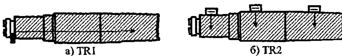
Рисунок 12 – Схемы прозвучивания осей колесных пар при вариантах методов TR1 и TR2
