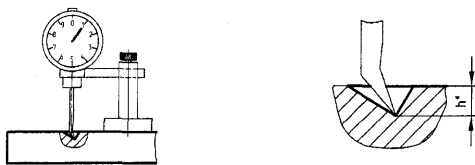
Рисунок Е.2 - Схема измерения глубины фрезерования сегмента
