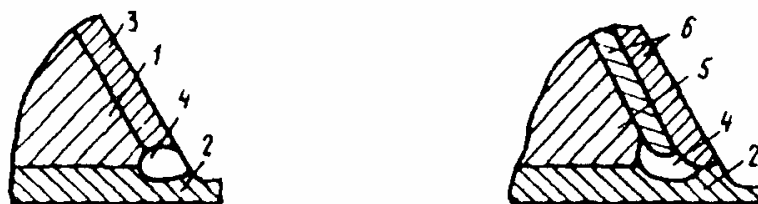
Рис. 3. Схема выполнения предварительной наплавки кромок деталей из двухслойных сталей с плакирующим слоем, содержащим ниобий:
