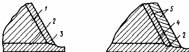
Рис. 2. Схема выполнения предварительной наплавки кромок деталей из двухслойных сталей с плакирующим слоем, не содержащим ниобий:
